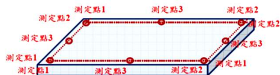
圖 6.3-1 型模邊長、水平度量測點位示意圖
